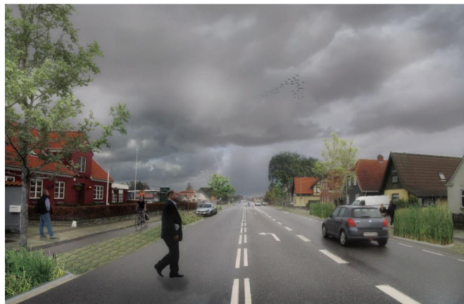
Visualisering fra Ringsted Kommunes Handleplan for klimatilpasning, som viser, et eksempel på udformning og placering af regnvandsbede langs med Roskildevej.
