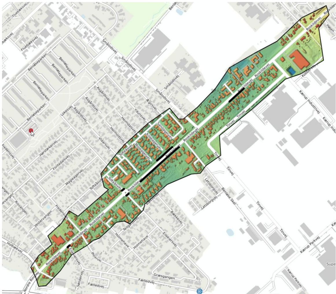
Figur 1 Anvendt terrænmodel (fra Scalgo). Digital Højde Model data fra 2015. Af beregningsmæssige grunde, er terrænmodellens udstrækning afgrænset til det viste. Eventuel tilstrømning fra de tilstødende områder simuleres således ikke. Særskilte skybrudstiltag er markeret med sort streg.
