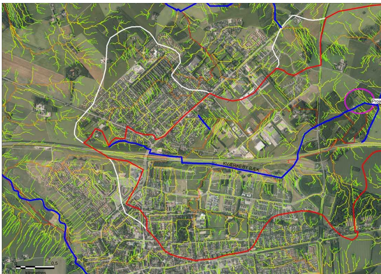
Figur 2-4 Korrektion af opland til Kværkeby Bæk. Hvid kurve angiver tidligere anvendt oplandsgrænse. Rød linje angiver revideret oplandsgrænse. Strømningsveje er angivet med start i grøn linje der fortsætter over i orange til rød.
