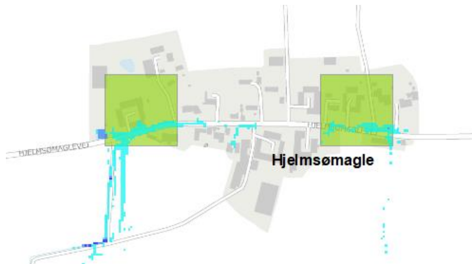
Kort 6: Viser de gennemsnitlige årlige skadesomkostninger i Hjelmsømagle ved en 100 års regnhændelse i år 2067.
