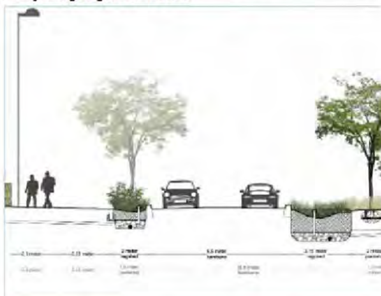
Principsnit af den fremtidige afvanding af Roskildevej.
