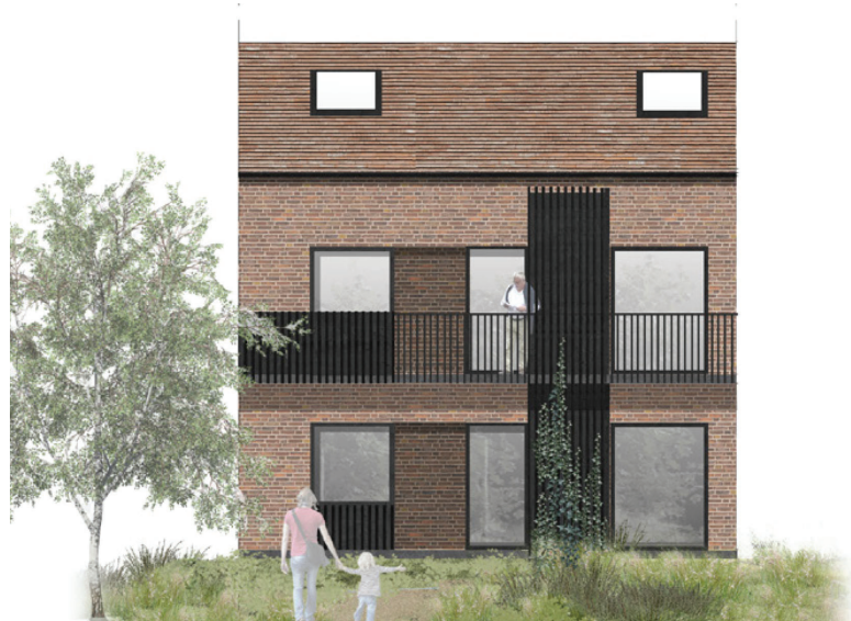
Eksempel på indre teglfacader, suppleret med træbeklædning f.eks. i form af espalier til klatreplanter
