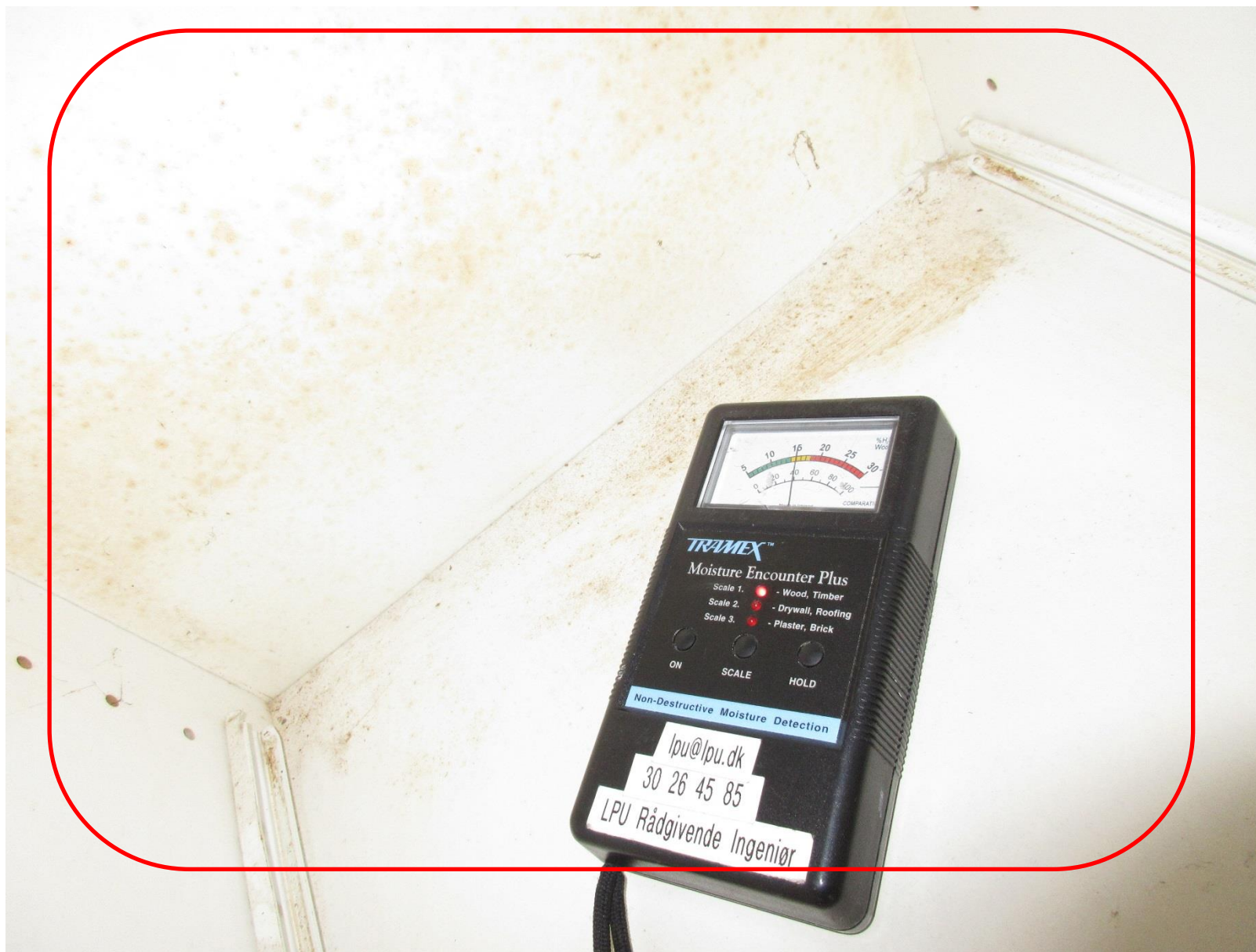
Stueetagen – køkkenet – synlig skimmelvækst i køkkenskabet – let forhøjet fugt i køkkenskabet (RV 16 med Tramex)
