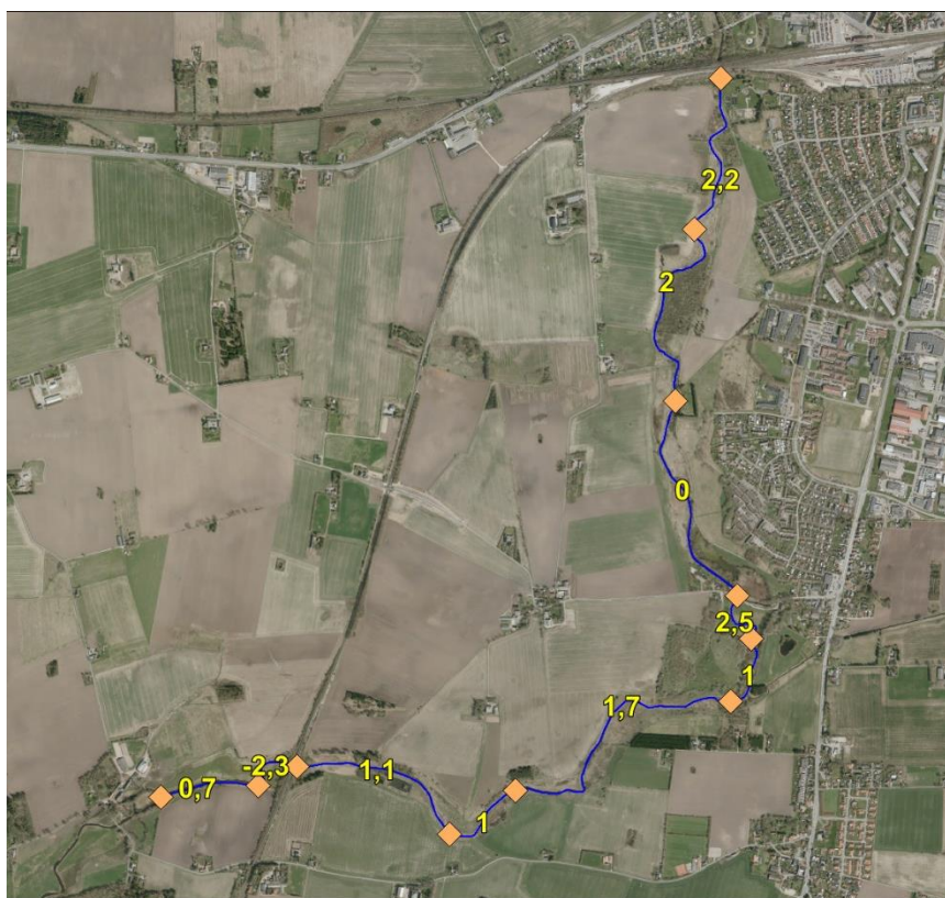
Figur 3-3 Oversigt over faldforhold på de enkelte delstrækninger af Ringsted Å på strækningen fra st. 9.500 til st. 15.500
