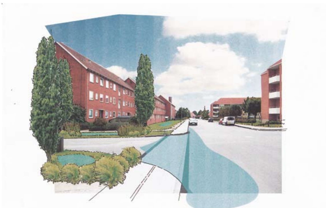
Ved vejkruds forlænges fortovet og der laves vejbump, som skaber trykthed for trafikanter og forsinket strømning ad Fynsgade med kontrollerede overløb under kraftig regn.
