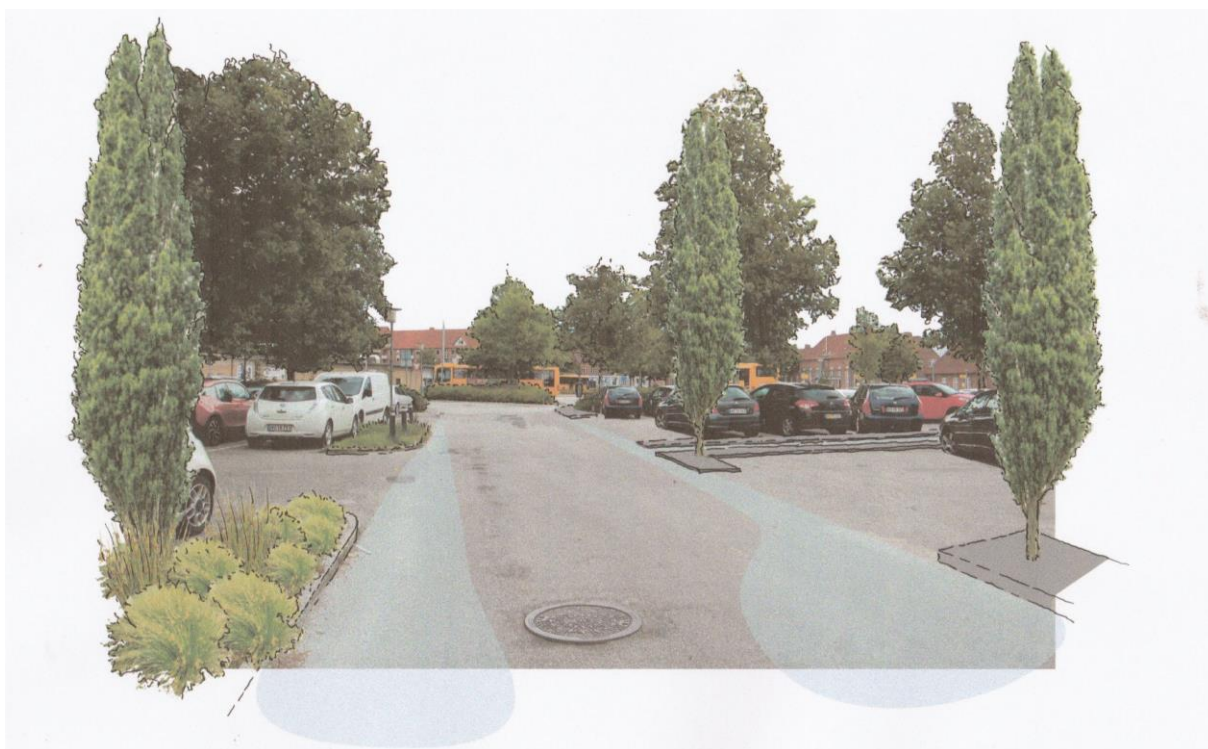
Figur 8. Løsningsforslag til Parkeringsarealet i stationsområdet, som kan håndtere og opmagasinere regnvandet med terrænregulering, vandkanaler og tunnelfaskiner inden overløb til den kommende rensespark sydvest for Dagmarskolen.
