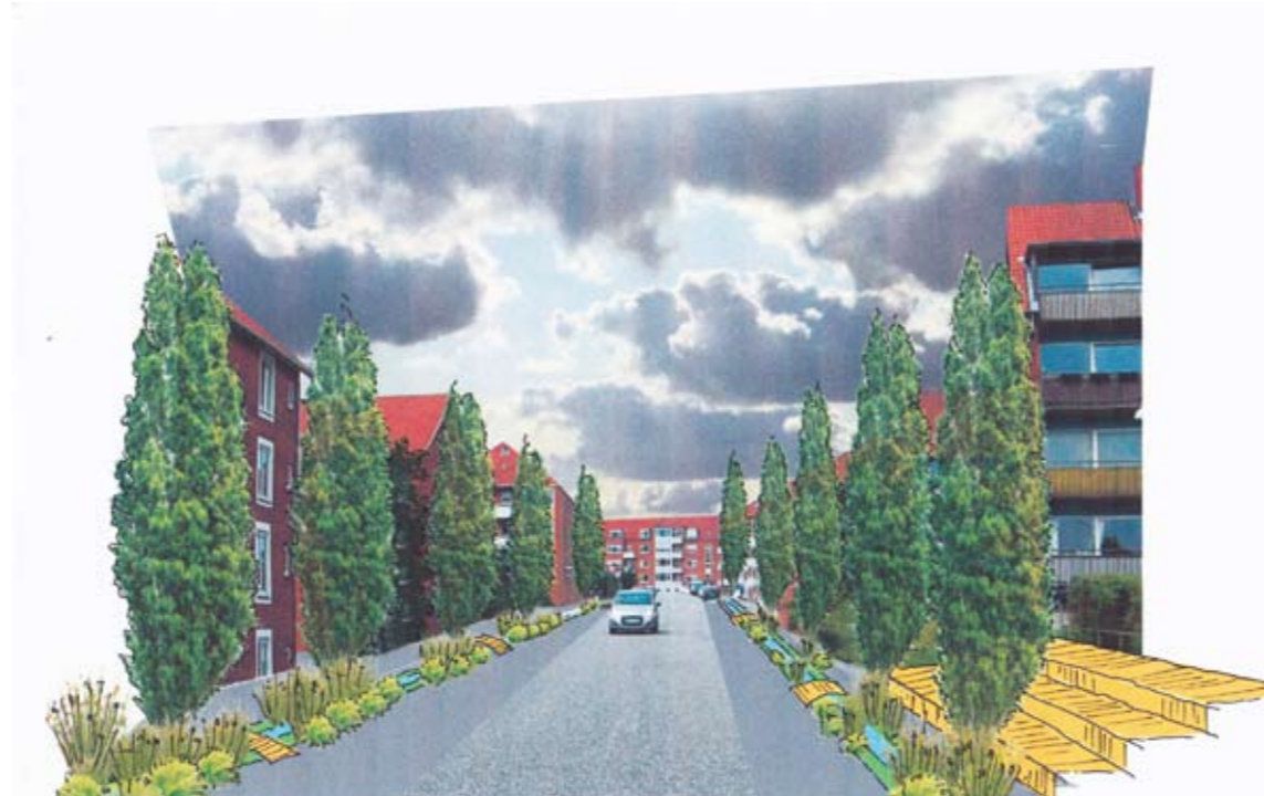
Løsning hvor Fynsgade bliver en rolig grøn allé med broelementer, og regnvand håndteres i vandkanaler i begge sider.
