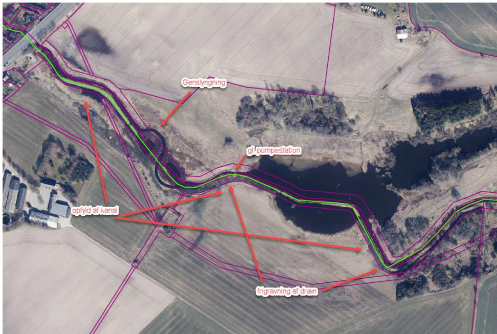
Figur 33 Luftfoto efter realisering med angivelse af tiltag opstrøms Roskildevej. Grøn linje angiver oprindeligt trace.
