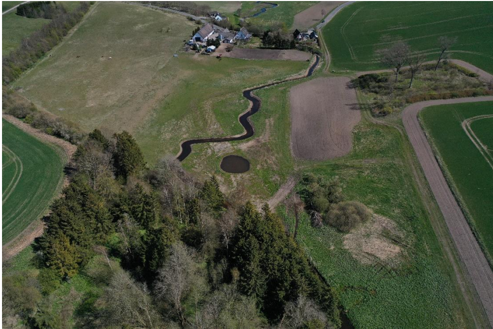
Figur 20 Luftfoto fra droneoverflyvning efter realisering. Paddehul ses tydeligt, og det gamle trace kan anes som en lys linje der har et forløb gennem paddehullet.
