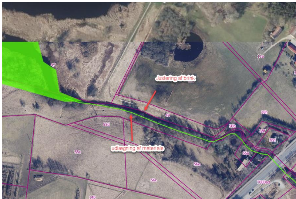
Figur 45 Luftfoto efter realisering med angivelse af steder for tiltag. Grøn linje angiver oprindeligt trace.
