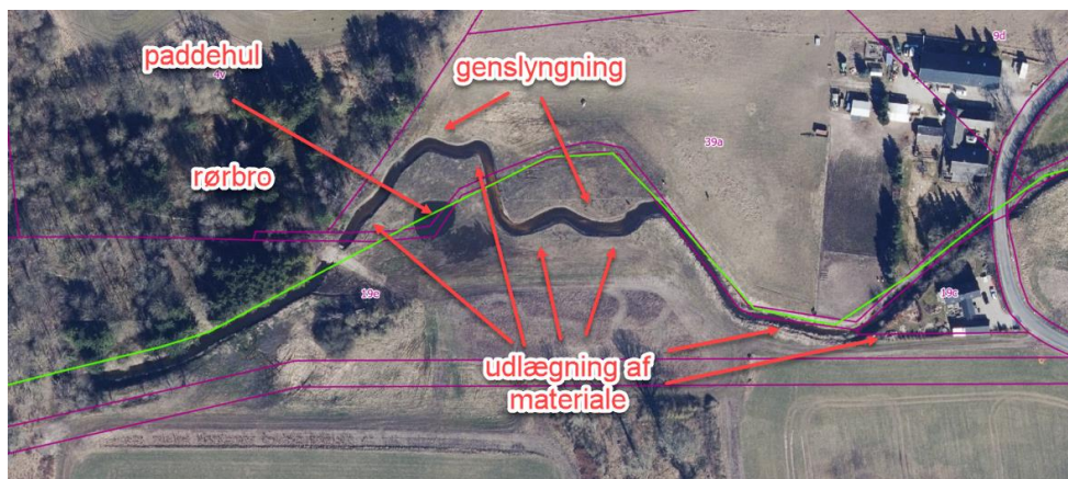
Figur 19. Luftfoto efter realisering med angivelse af tiltag. Grøn linje angiver oprindeligt trace.
