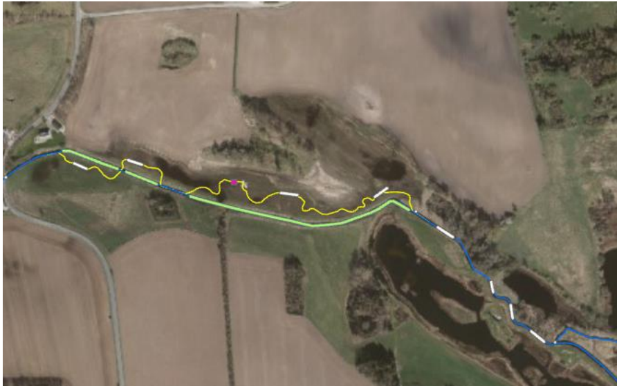
Figur 7 Fra projektplan: Udlægning af groft materiale (hvid markering). Genslyngning (gul markering) rørbro (lilla markering), hvor både bro og slyng er blevet justeret.
