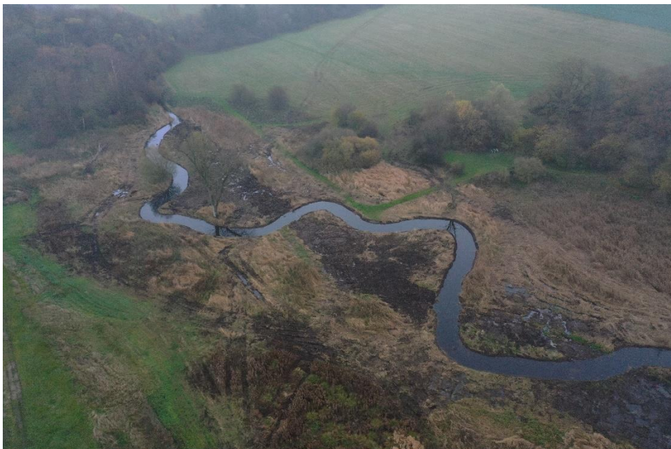
Figur 31. Dronefoto efter genslyngning. Gammelt trace anes som en mørk linje i terrænet
