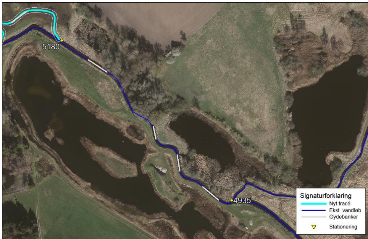
Figur 17. Udskiftning af bund fra St. 4.935 – 5.150 m.
