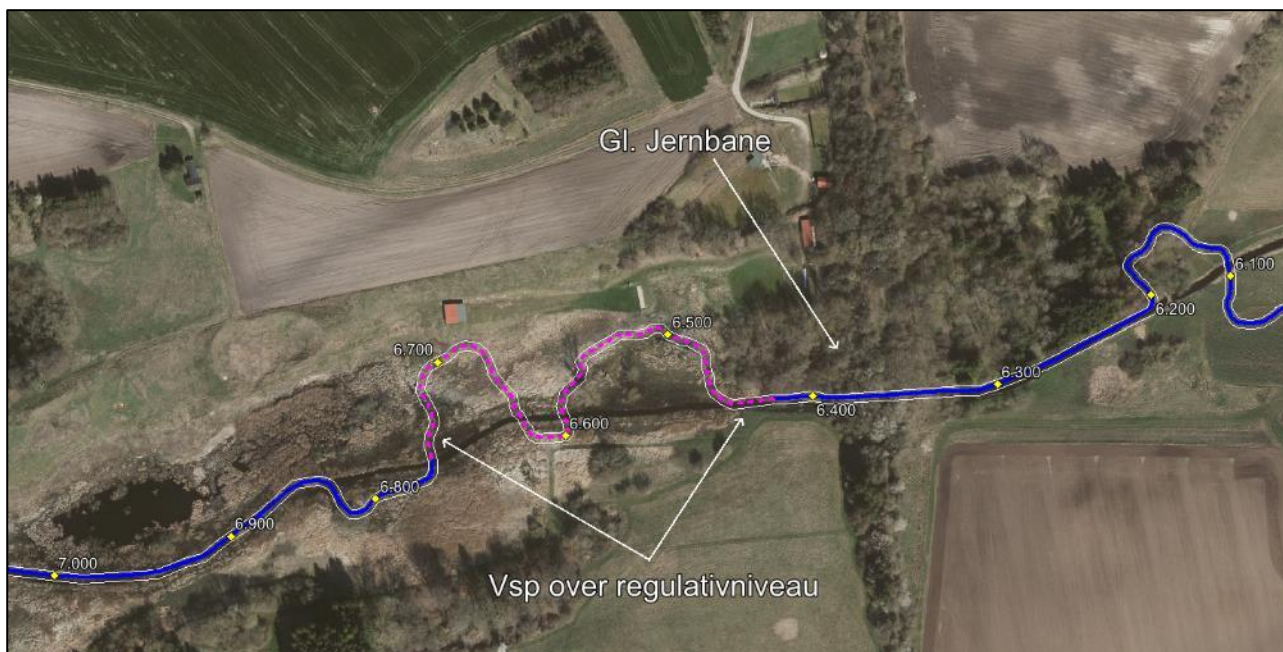
Figur 34. Eneste sted hvor vandspejl kommer over regulativniveau er på en ca. 300 m lang strækning nedstrøms den gl. jernbanebro.
