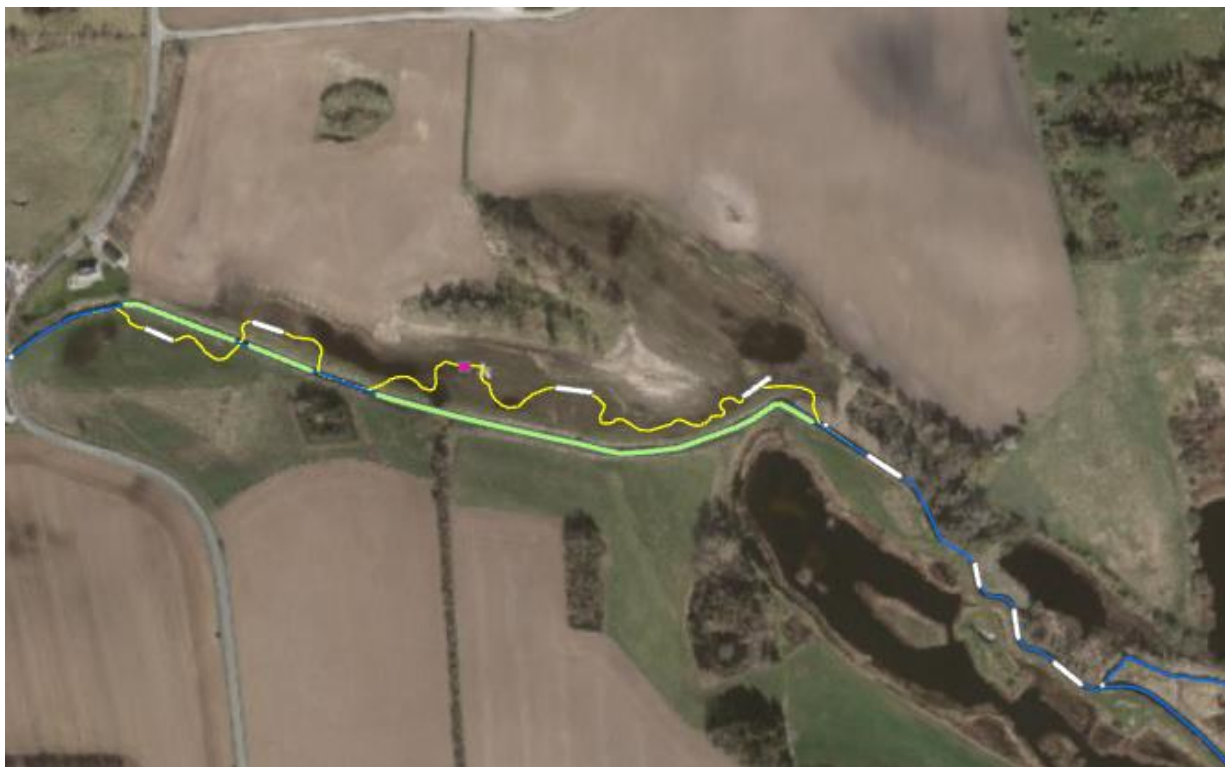
Figur 4. Projektkort over indsatser opstrøms Værkevadsbro. Gul= genslyngning, hvid=udlægning af materiale, grøn= opfyld af eksisterende vandløb, lilla=rørbro.
