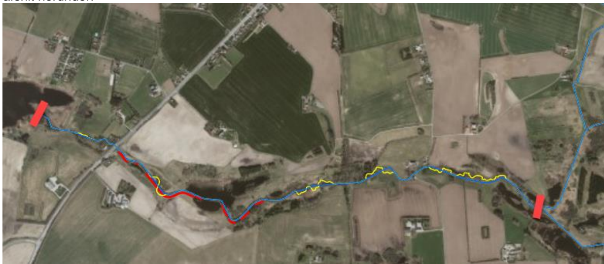
Figur 1. Den samlede projektstrækning med markering af de primære tiltag med genslyngninger (gul) og opfyld af kanal (rød).
