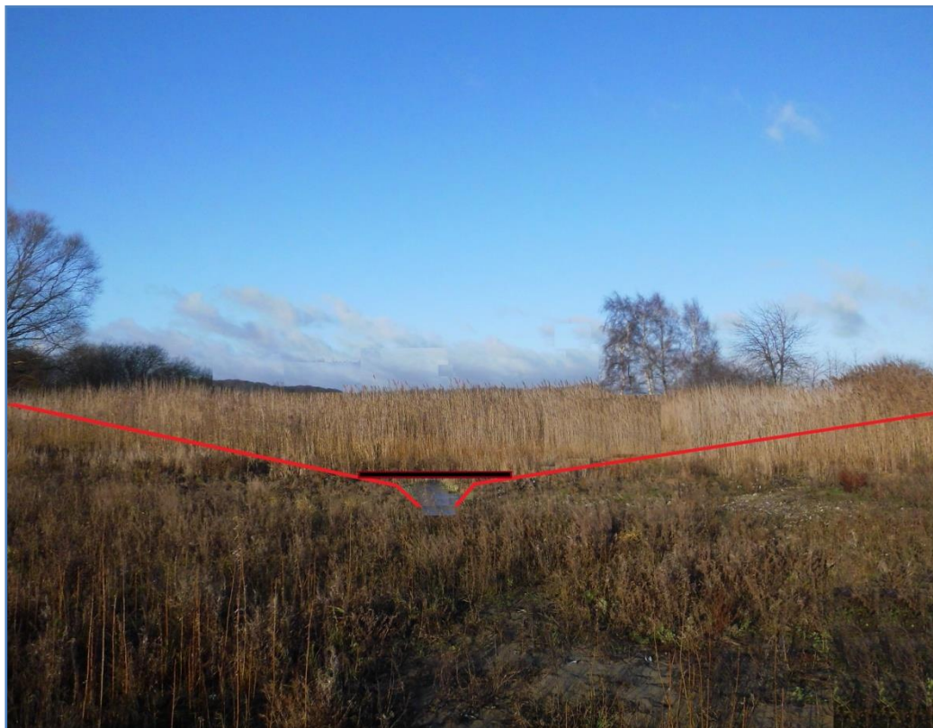
Figur 2.3.: Principskitse af afgravning af dige vist med rød linje (ikke målfast). Fotomanipulation.
