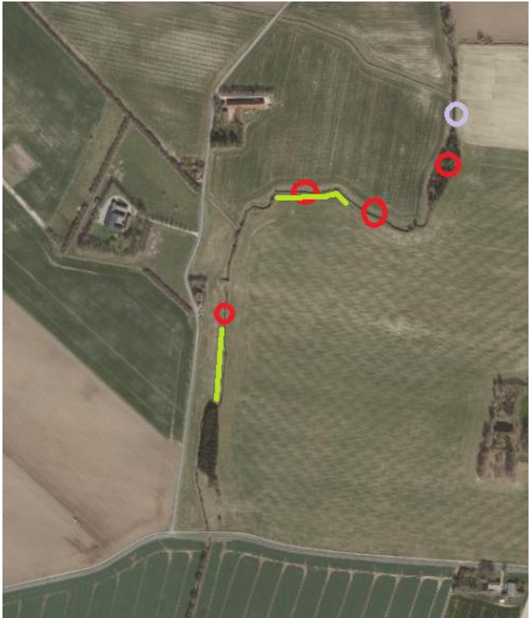
Figur 3.2.: Aktiviteter, strækning 1: Lilla cirkel: Sandfang, Rød cirkel, Stryg, Grøn linje: plantering af træer.
